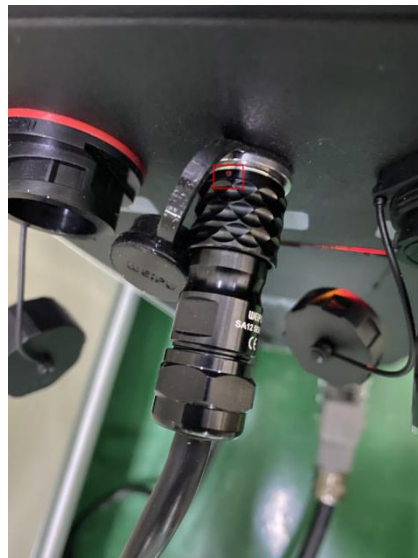
图 4.4 急停开关连接
